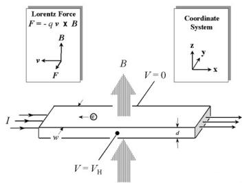
è il valore dell'induzione magnetica, I la corrente che scorre nel sensore,  $V_H$  è la tensione di Hall. Nota la costante possiamo ricavare B dalle misure di I e  $V_H$ :
